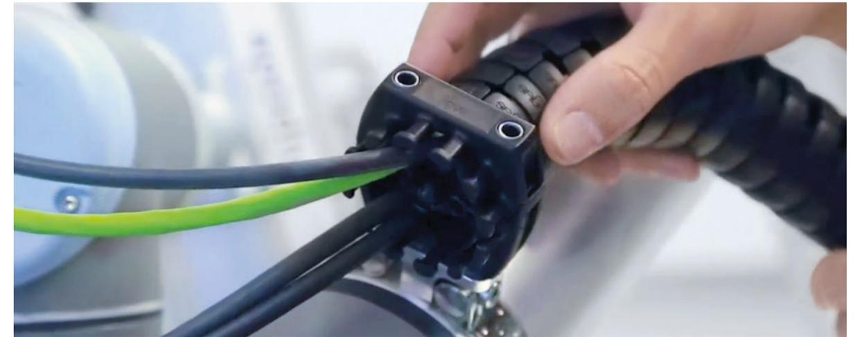
Abb. 18: Installation eines Leitungskanals (6)
